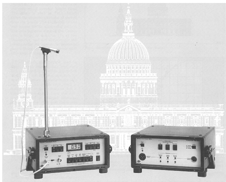
Figura 4.4 - Equipamento para medição do parâmetro RASTI, desenvolvido pela "Brüel & Kjaer".
