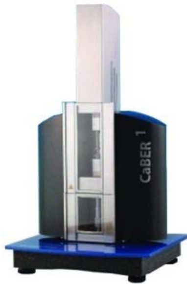
Figura 3.7 : Reómetro HAAKE CaBer1 da “Thermo Electron Corporation” onde se realizaram os ensaios reológicos elongacionais
