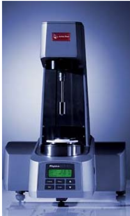
Figura 3.3: Reómetro Physica MCR301 onde se realizaram os ensaios reológicos
