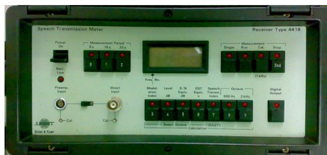
Figura 5.4. – Receptor de RASTI tipo BK4419 da Brüel & Kjær [Foto do autor].
