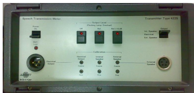
Figura 5.3. – Transmissor de RASTI tipo BK4225 da Brüel & Kjær [Foto do autor].
