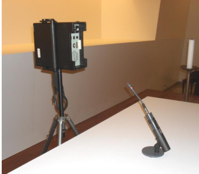
Figura 5.18. – Emissor do sinal sonoro (RASTI) localizado no altar na posição do orador a cerca de 30 cm de distância do microfone [Foto do autor].
