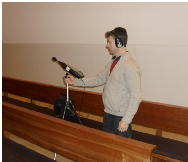
Figura 5.8. – Registo do tempo de reverberação por parte do sonómetro [Foto do autor].
