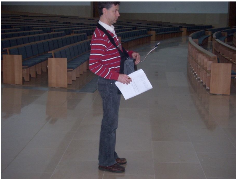
Figura 5.8. – Recepção do sinal sonoro para avaliação do RASTI. [Foto do Autor]
