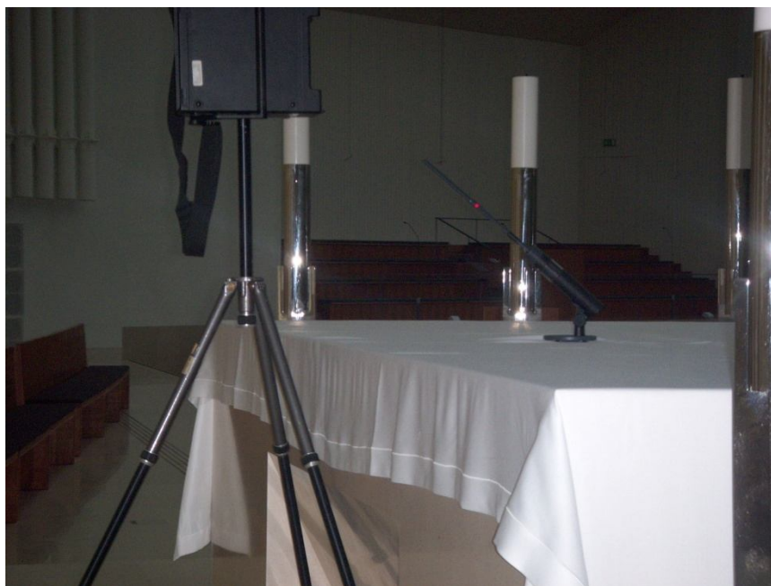
Figura 5.9. – 2ª fase do ensaio de RASTI com sistema de som ligado [Foto do Autor]
