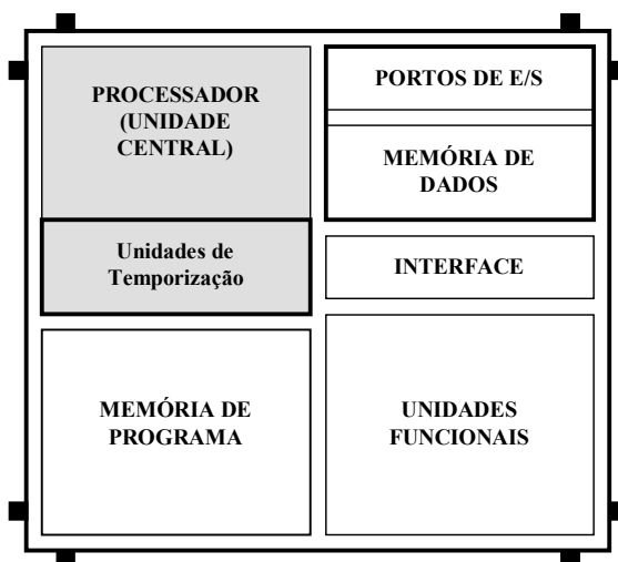
Figura 1.2. Arquitectura do sistema alvo para o ambiente de co-síntese.
