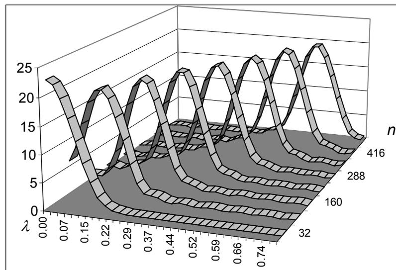
Figura 4.26. Transformadas de Fourier correspondentes às várias translações da janela de Kaiser.
