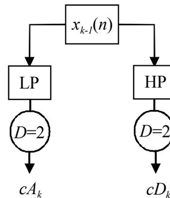
Figura 4.35. Decomposição de um sinal em aproximação  $cA_k$  e detalhe  $cD_k$ .
