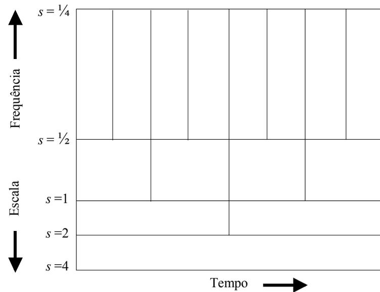
**Figura 4.33. Representação diádica da transformada discreta de ondas.**
