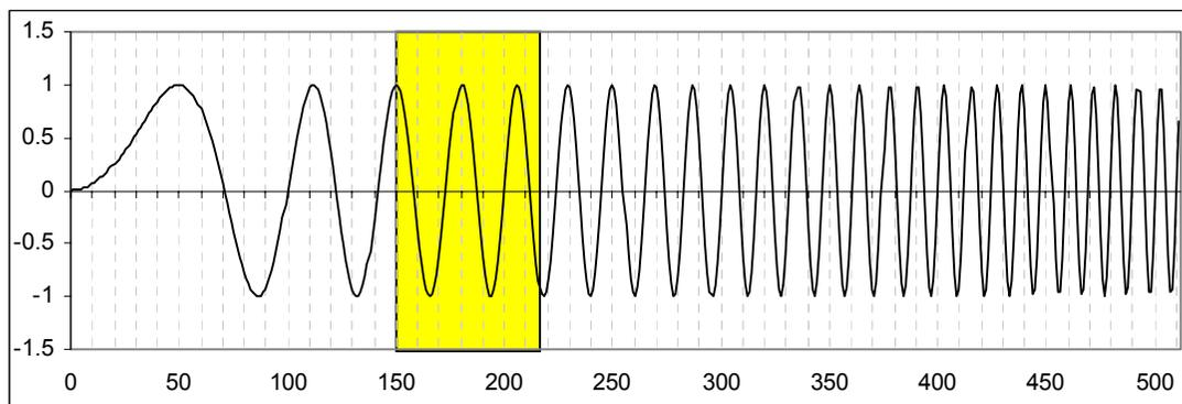
Figura 4.24. Cirp linear com  $f_0 = 0.4 \times 10^{-3}$  (512 amostras) e uma janela de 64 amostras.
