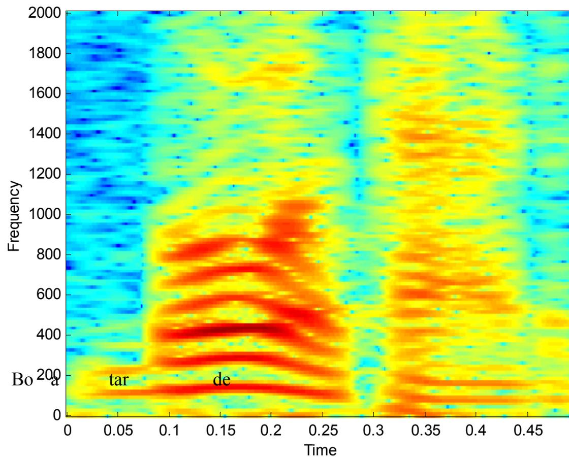
**Figura 4.31. Espectrograma do sinal anterior (Matlab: `specgram(x, 256, 4009, hanning(256), 250)`). A transição entre fonemas é visível.**
