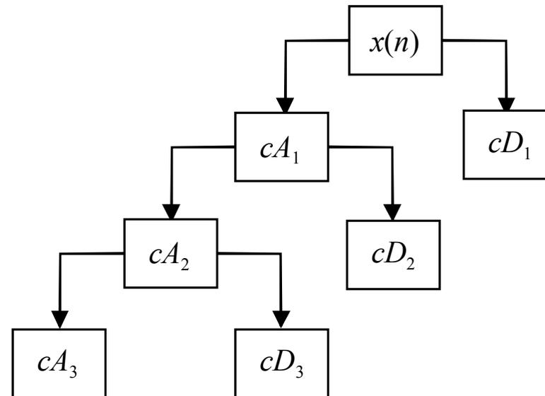
**Figura 4.36. Decomposição multinível (3 níveis) de um sinal em aproximações e detalhes.**
