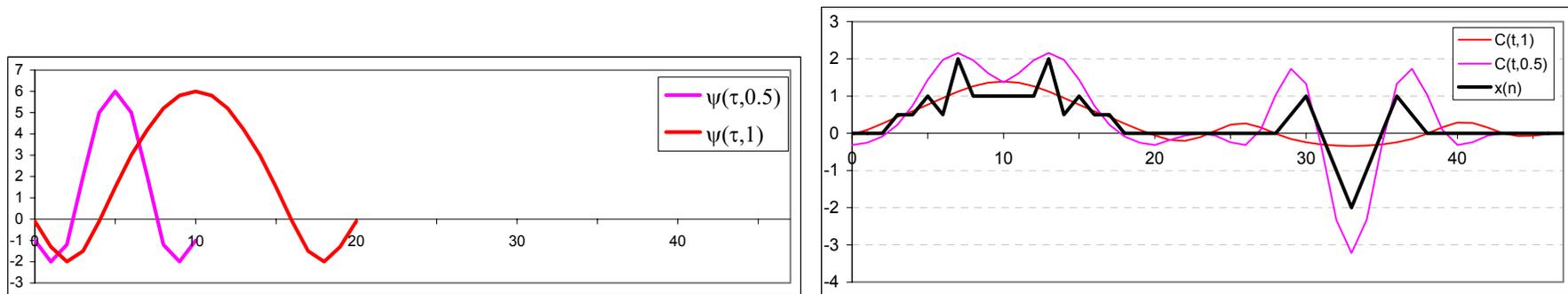
Figura 4.32. Exemplo de duas ôndulas, a ôndula mãe para  $a=1$  e outra comprimida para metade, e o resultado da sua aplicação a um sinal. Notar a descrição proporcionada pelas duas ondas.
