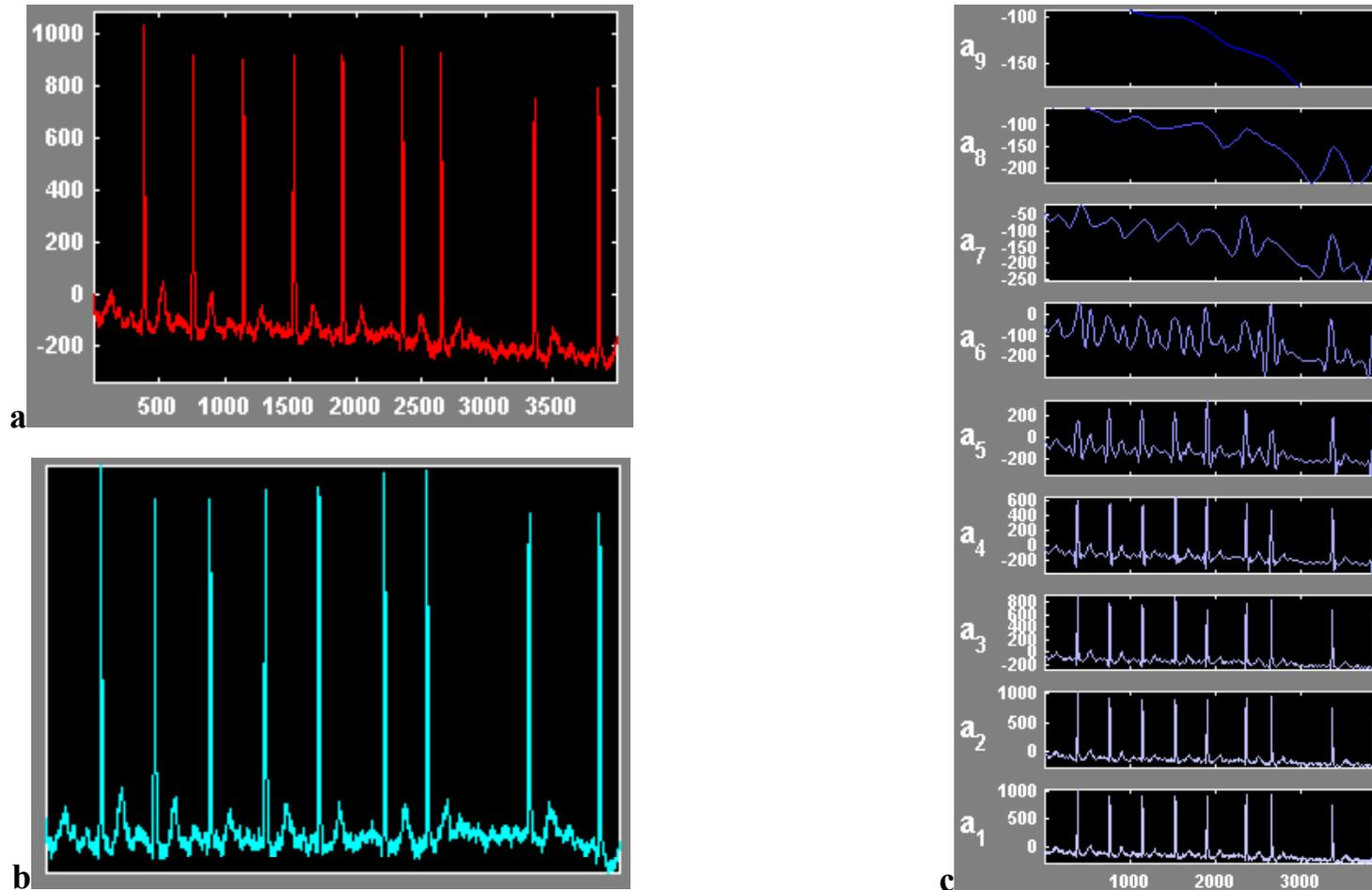
Figura 4.41. Sinal ECG original (a) e sinal reconstruído (b) usando só os detalhes de uma decomposição em 9 níveis (c), usando a ôndula Daubechies db5.
