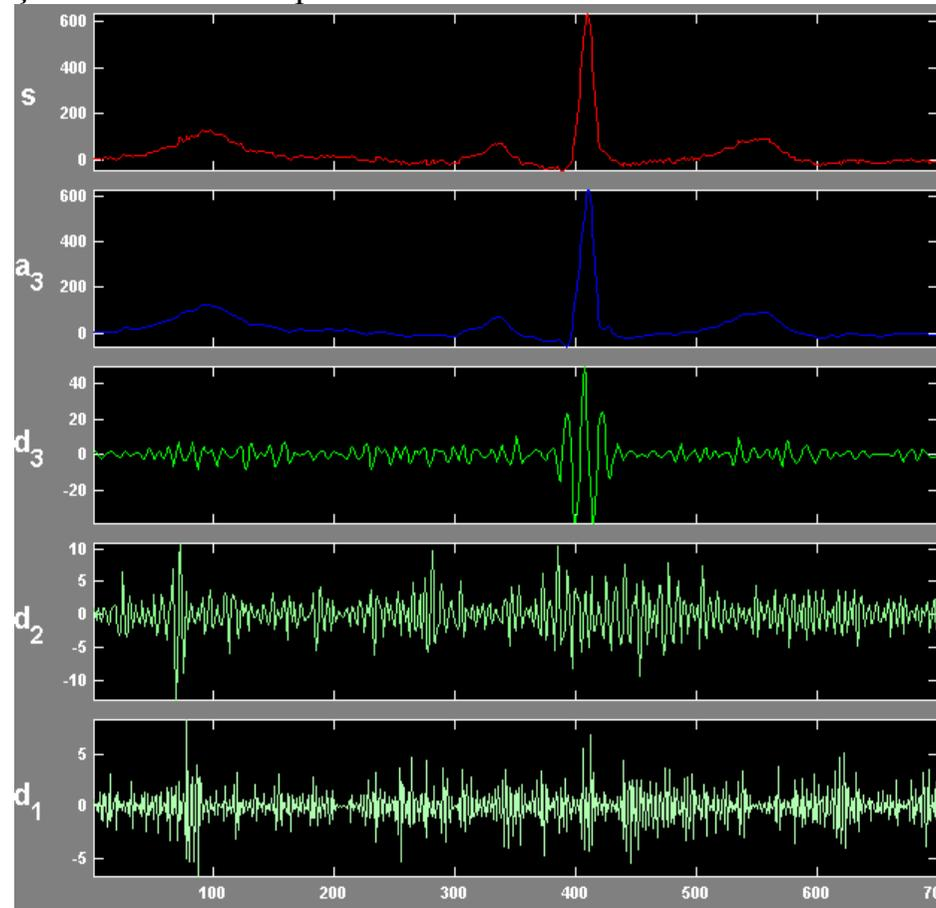
Figura 4. 37. Aproximações e detalhes na análise do ECG usando a ôndula coiflet de ordem 3. Notar que o detalhe d3 só ocorre no segmento QR do sinal.
