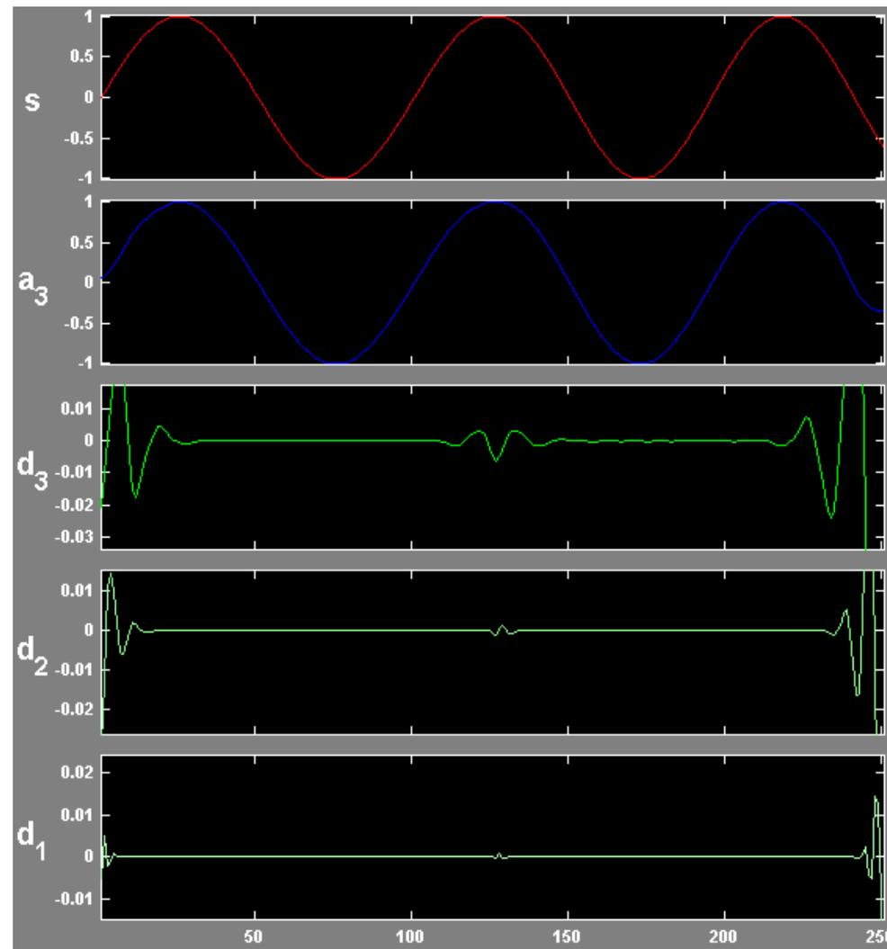
Figura 4.40. Detalhes mostrando uma descontinuidade imperceptível (ôndula coif3; 3 níveis).
