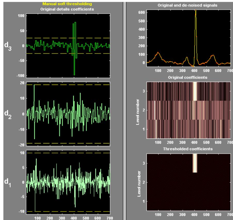
Figura 4.38. Remoção e limitação de detalhes para o ECG anterior.
