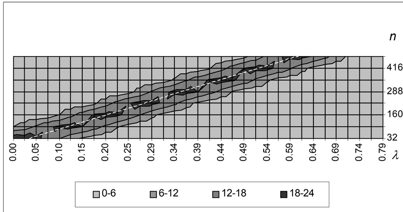
Figura 4.25. Espectrograma do chirp linear. A inclinação da recta que passa pelos máximos corresponde à frequência instantânea.
