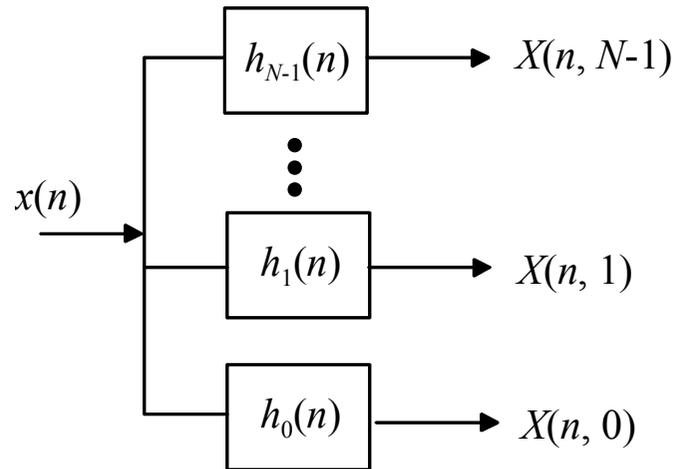
Figura 4.27. Obtenção da STFT por um banco de filtros.
