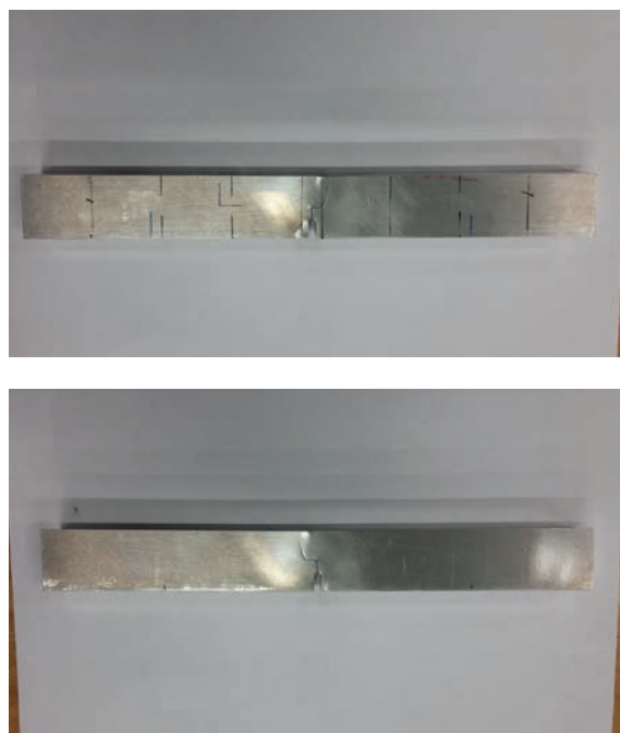
Figura 5 – Exemplo de desvio da direcção de propagação de uma fenda devido a alteração da razão modo I / modo II: provete de flexão em 4 pontos de AA 6082 T6 ensaiado na FEUP por J. Baganha Marques, 2017.
